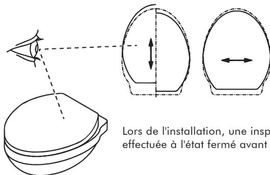
Lors de l'installation, une inspection visuelle doit être effectuée à l'état fermé avant le serrage des vis.
