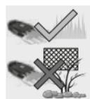
Achten Sie beim Schneiden darauf, dass keine Gegenstände wie Draht, Metallteile, Steine usw. in das Messer gelangen
