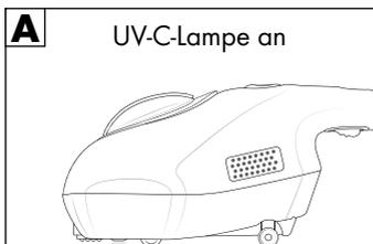
Verlieren die Sicherheitsschalter den Kontakt zum Untergrund, wird die Abschaltautomatik aktiviert und die UV-C-Lampe ❸ hört auf zu leuchten (Abb. B und C).
