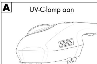
Als de veiligheidsschakelaars het contact met de ondergrond verliezen, wordt de automatische uitschakeling geactiveerd en schakelt de UV-C-lamp ⑧ uit (afb. B en C).
