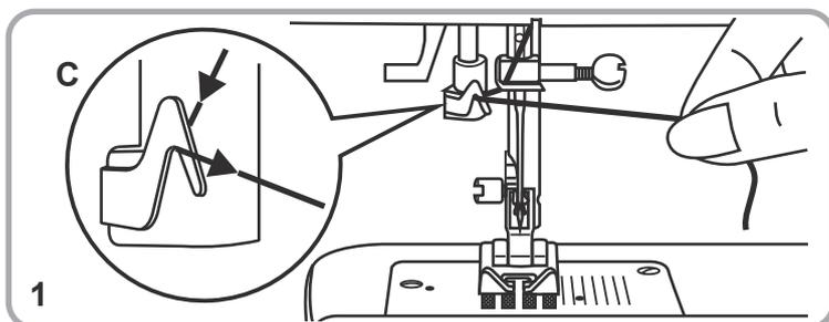
1. Senken Sie den Nähfuß (9) ab. Führen Sie den Faden entlang der Fadenführung (C).
