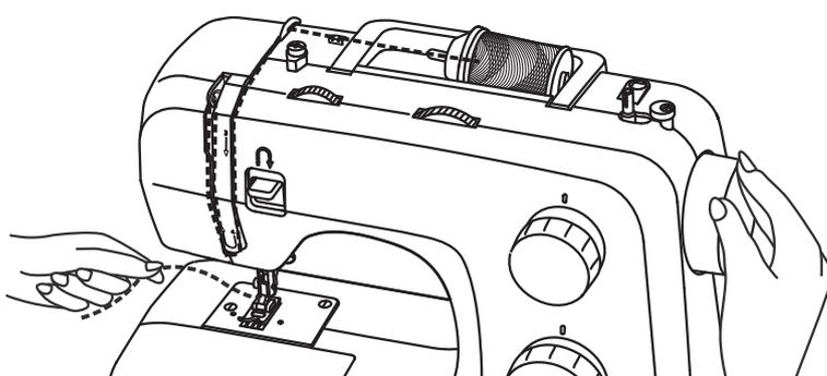
Ende des Oberfadens mit der Hand halten. Das Handrad (21) gegen den Uhrzeigersinn drehen, bis die Nadel wieder oben steht (eine volle Umdrehung).
