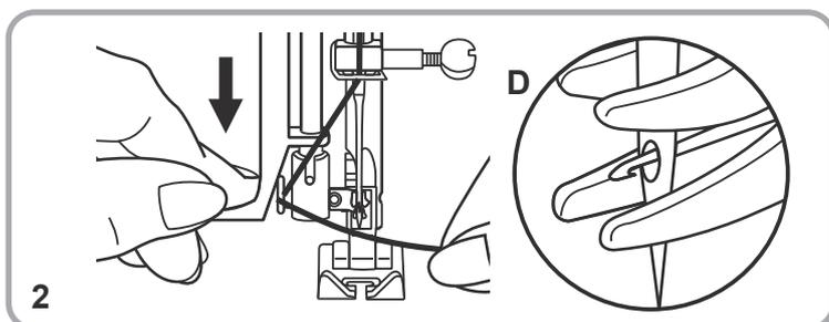
2. Drücken Sie den Hebel so weit wie möglich nach unten. Der Nadeleinfädler dreht sich automatisch in die Einfädelposition, das winzige Häkchen schiebt sich dabei durch das Nadelöhr (D).
