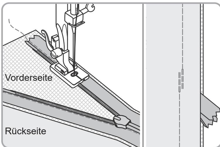
Zum Befestigen der anderen Reißverschlusshälfte legen Sie die Hälfte mit der Vorderseite nach unten wie zuvor an: So, dass die Spirale auf der Nahtlinie (1.6 cm), der obere Anschlag 1.9 cm unter der Schnittkante des Stoffes liegt. Anschließend mit Nadeln feststecken. Achten Sie darauf, dass der Reißverschluss am unteren Ende nicht verdreht ist. Nutzen Sie die linke Vertiefung des Fußes, achten Sie darauf, dass die Mittelmarkierung wie zuvor in einer Linie mit Nadel und Stich verläuft.
