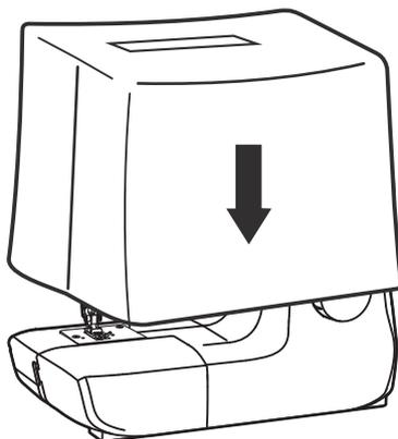
Bei Nichtgebrauch der Nähmaschine immer Netzstecker ziehen. Verwenden Sie die mitgelieferte Staubschutzhülle (s).
