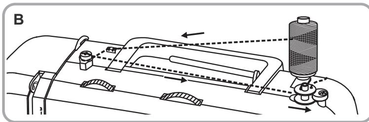
Faden von innen durch ein Loch der leeren Spule (g) nach außen ziehen. Spule (g) auf die Spuleinrichtung (14) stecken und dann nach rechts in die Spulposition drücken.
