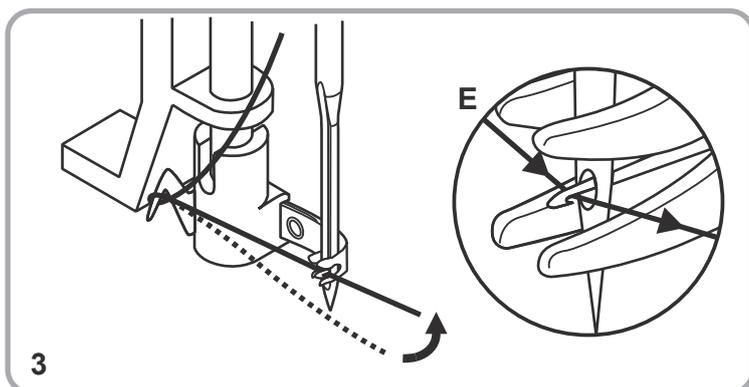
3. Führen Sie den Faden vor die Nadel, so dass er sich unterhalb des Häkchens (E) befindet. Halten Sie den Faden dann leicht nach oben, so dass er am Greiferhaken einhängt.
