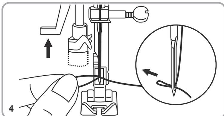
4. Halten Sie den Faden locker, lassen Sie dann langsam den Hebel los. Der Haken dreht sich, schiebt den Faden durch das Nadelöhr, wodurch sich eine Schlaufe bildet. Ziehen Sie den Faden ganz durch das Nadelöhr nach hinten.
