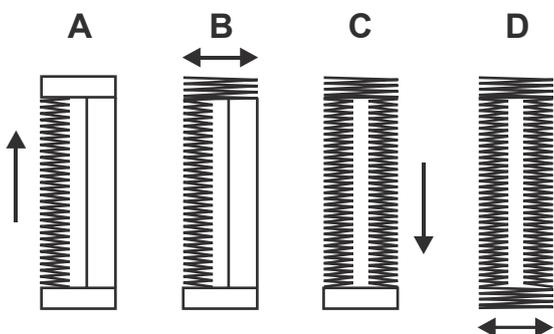
Den Nähfuß hochstellen. Den Stoff unter dem Nähfuß vorziehen und die Fäden abtrennen. Den Oberfaden auf die Rückseite durch den Stoff ziehen und Oberfaden und Unterfaden verknoten. Die Knopflochöffnung mit dem Nahttrenner (n) aufschneiden. Dabei darauf achten, nicht auf einer Seite in die Stiche zu schneiden.
