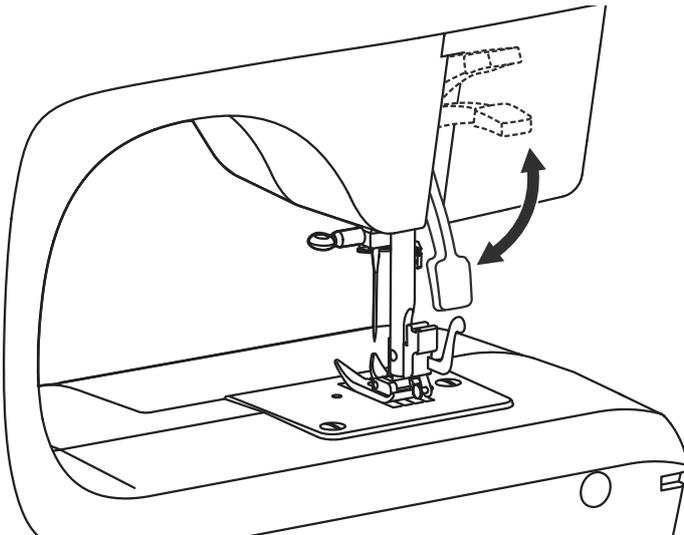
Beim Nähen von extrem dicken Stoffen kann der Stoffdurchgang unter dem Nähfuß (9) vergrößert werden, indem man den Zweistufen-Nähfußheber (18) weiter anhebt (Pfeil).
