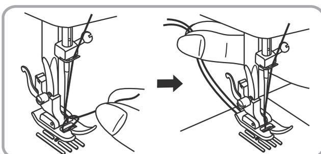
Am Oberfaden ziehen, damit der Unterfaden aus dem Stichloch gezogen wird. Beide Fäden unter dem Nähfuß (9) nach hinten legen.
