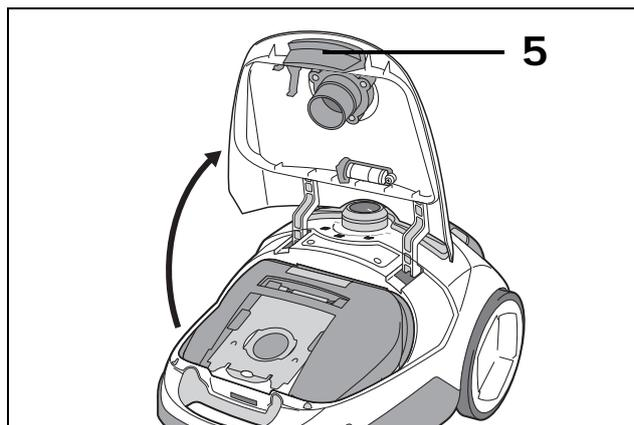
1. Drücken Sie die Entriegelungstaste **5** nach oben zum Deckel hin und klappen Sie den Deckel **3** hoch, bis er einrastet.
