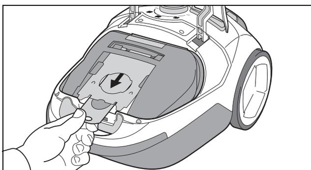
2. Verschließen Sie die Öffnung des Staubbeutels: Halten Sie dazu mit einer Hand das Oberteil des Staubbeutels hinten fest und ziehen Sie die Lasche heraus.
