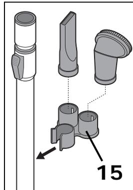
Möbelbürste **14** und Fugendüse **13** sind immer zur Hand, wenn Sie diese in der Halterung **15** aufbewahren. Die Halterung kann an das Teleskoprohr **9** gesteckt werden.
