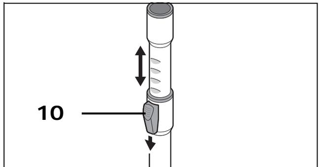
1. Drücken Sie den Schieber **10** am Teleskoprohr **9** nach unten und stellen Sie die gewünschte Länge ein.
