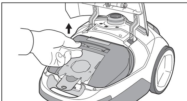
3. Heben Sie die Staubbeutel-Halterung aus dem Staubsauger heraus.
