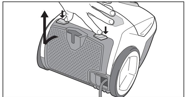
1. Drücken Sie gleichzeitig die beiden Entriegelungstasten **17** an der Rückseite des Staubsaugers.
