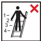
**FR** **BE** Ne pas monter au-dessus des quatre échelons/barreaux supérieurs de l'échelle lorsqu'elle est en position droite avec sa partie télescopique déployée vers le haut. Ne pas monter au-dessus des quatre échelons/barreaux supérieurs de l'échelle en position d'escalier.
