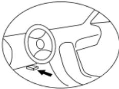
Deze wordt gebruikt om de motor te controleren van alle voertuigen die voldoen aan OBD II. 12 V-spanning met gestandaardiseerde 16-polige connector **[7]**. Locatie van de Data Link Connector (DLC)
