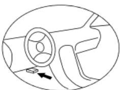
Il sert à contrôler le moteur de tous les véhicules conformes à OBD II. Tension de 12 V avec connecteur normalisé à 16 cavités **7**. Emplacement du connecteur de liaison de données (DLC) Le DLC est
