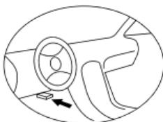
Dieser wird verwendet, um den Motor aller OBD II-konformen Fahrzeuge zu überprüfen. 12 V Spannung mit standardisiertem 16-poligem Stecker **7**. Lage des Data Link Connector (DLC) Der
