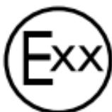
Das E-Kennzeichen ist ein Prüfzeichen für die Kennzeichnung von genehmigungspflichtigen Bauteilen an Kraftfahrzeugen und besagt, dass die erforderlichen Prüfungen durchgeführt wurden und eine ECE-Bauartgenehmigung erteilt wurde.
