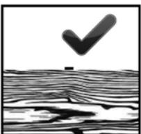
De bovenkant van het nietje resp. de spijkerkop dient zoals weergegeven vlak op de bovenkant van het te bevestigen materiaal te liggen.
