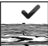
Comme illustré, le dessus de l'agrafe voire la tête du clou doit être planté de façon à affleurer la surface du matériau à fixer.
