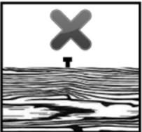
Wenn die Klammeroberseite / der Nagelkopf nicht bündig auf der Oberseite des zu befestigenden Materials aufliegt, haben Sie eine zu lange Klammer / einen zu langen Nagel verwendet. Verwenden Sie in diesem Fall die nächstkleinere Größe, um ein optimales Arbeitsergebnis zu erzielen.
