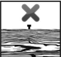
Hvis klammens overside hhv. sømhovedet ikke er fast sammenpresset med det materiale som skal fastgøres, har du brugt en for lang klamme / et for stort søm. Anvend i dette tilfælde den næstmindste størrelse, for at åbne et optimalt resultat.
