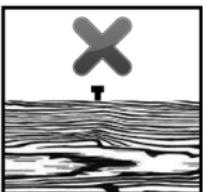
Als de bovenkant van het nietje/de spijkerkop niet vlak op de bovenkant van het te bevestigen materiaal ligt, heeft u een te lang nietje/spijker gebruikt. Gebruik in dit geval de volgend kleinere grootte, om een optimaal resultaat te bereiken.
