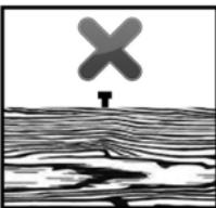
Lorsque le dessus de l'agrafe / la tête du clou n'est pas planté en affleurant bien la surface du matériau à fixer, vous avez utilisé une agrafe trop longue / un clou trop long. Dans ce cas, utilisez ensuite une agrafe / un clou de dimension directement inférieure, afin d'obtenir un résultat optimal.
