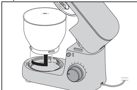
3. Verrouillez le bol mélangeur **5** en le tournant en direction du symbole représentant un cadenas fermé jusqu'à ce qu'il soit bloqué.
