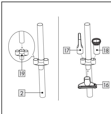
Die folgenden Zubehörteile können an der Düsenhalterung **19** angebracht werden, wenn sie nicht in Gebrauch sind:
