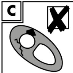
⚠ **Sobald das Befestigungselement Brüche oder Risse an der Öse zeigt, darf die Schaukel nicht mehr benutzt werden (Abb. C).**
