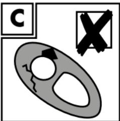
⚠ En cuanto el elemento de fijación presente roturas o grietas en el ojal superior, no debe usarse más el columpio (Figures C).
