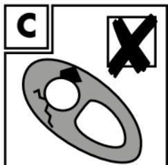
**Dès que l'élément de fixation présente des fêlures ou des fissures sur la boucle supérieure, la balançoire ne doit plus être utilisée (fig. C).**
