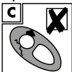
**⚠ Akonáhle sa na hornom oku upevňovacieho prvku objavia lomy alebo trhliny, nesmie sa viac hojačka používať (obr. C).**
