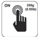
Ce symbole indique que la balance de cuisine s'allume automatiquement en présence d'une charge d'au moins 250 g ou 0,55 lb sur la surface de pesée (1).
