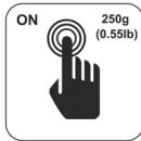
Dieses Symbol kennzeichnet, dass die Küchenwaage automatisch einschaltet, wenn die Wiegefläche (1) mit mindestens 250 g bzw. 0,55 lb belastet wird.
