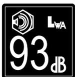
Niveau de puissance acoustique garanti de l'appareil
