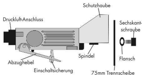
Druckluftzufuhr und Anschluss. Nur gefilterte, geschmierte und regulierte Druckluft verwenden. Folgendes Bild zeigt die richtige Anschlussmethode an das Druckluftsystem, was die Wirksamkeit und Lebensdauer des Werkzeuges erhöht.
