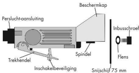
Persluchttoevoer en aansluiting. Gebruik alleen gefilterde, gesmeerde en geregelde perslucht. De volgende afbeelding toont de juiste aansluitmethode op het persluchtsysteem, wat de werking en levensduur van het gereedschap verhoogt.
