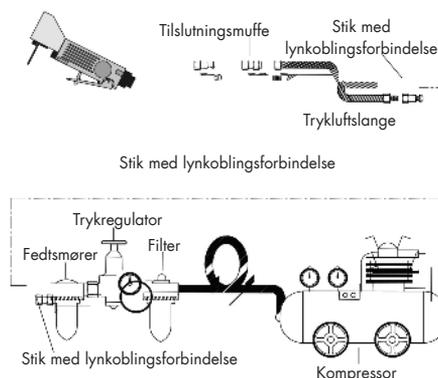
Tilfør inden første brug og med jævne mellemrum nogle dråber olie til trykluffapparater eller motorolie SAE 10-20 i trykluffapparatets tryklufftilslutning. Hver 3. – 4. driftstime skal oliereservoirets lukkeskrue [9] fjernes med montagenøglen. Oliereservoiret fyldes med olie til trykluffapparater eller motorolie SAE 10-20, og lukkeskruen drejes ind igen. Lufttilslutningernes gevind omvikles med noget teflon-tætningsbånd. Skru lufttilslutningerne ind i trykluffapparaterne.
