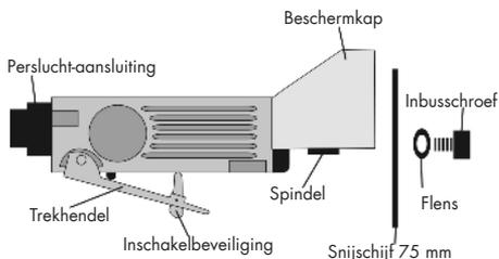
Persluchttoevoer en aansluiting. Gebruik alleen gefilterde, gesmeerde en geregelde perslucht. De volgende afbeelding toont de juiste aansluitmethode op het persluchtstelsel, wat de werking en levensduur van het gereedschap verhoogt.
