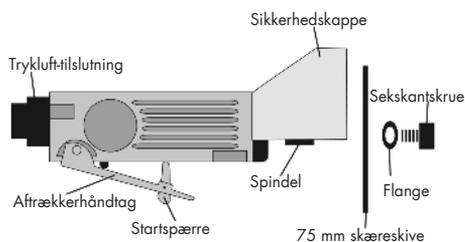
Tryklufforsyning og tilslutning. Brug udelukkende filterret, smøret og reguleret trykluft. Det følgende billede viser den korrekte tilslutningsmetode til trykluffsystemet, som øger værktøjets effektivitet og levetid.
