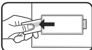
V spodnej časti osobnej váhy odstráňte pásičku z priestoru pre batériu (4). Osobná váha je teraz pripravená na používanie.
