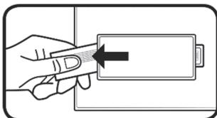
Entfernen Sie den Streifen vom Batteriefach (4) auf der Unterseite der Personenwaage. Die Personenwaage ist jetzt betriebsbereit.
