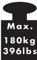
Tento symbol naznačuje, že maximálna záťaž osobnej váhy je 180 kg alebo 396 lb. Pri prekročení maximálnej záťaže sa môže osobná váha poškodiť a môže dôjsť k zraneniu.
