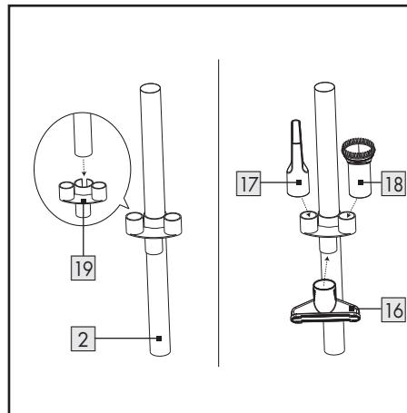
Die folgenden Zubehörteile können an der Düsenhalterung angebracht werden, wenn sie nicht in Gebrauch sind:
