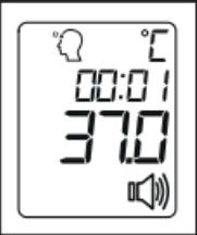
signaliseres med en kort biptone (hvis tastetenen er aktiveret). Så snart symbolet for målingstypen holder op med at blinke, er den næste måling mulig. Dette varer 5 sekunder.
