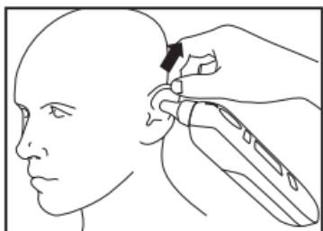
Sensorspitze **1** direkt auf das Trommelfell ausgerichtet werden kann.
