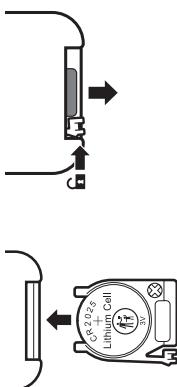
1. Appuyez le petit levier situé sur le côté du porte-pile **13** légèrement vers le centre et retirez ensuite le porte-pile de la télécommande **8** dans le sens de la flèche.
