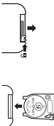
1. Drücken Sie den kleinen Hebel an der Seite des Batteriehalters **13** etwas in Richtung Mitte und ziehen anschließend den Batteriehalter in Pfeilrichtung aus der Fernbedienung **8**.
