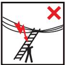
(DE) (AT) (CH) **Warnung, elektrische Gefährdung.** Alle durch elektrische Betriebsmittel im Arbeitsbereich gegebenen Risiken feststellen, z. B. Hochspannungs-Freileitungen oder andere freiliegende elektrische Betriebsmittel und die Leiter nicht verwenden, wenn Risiken durch elektrischen Strom bestehen.
