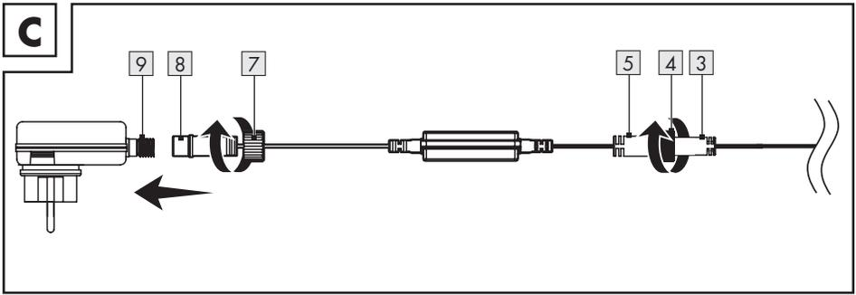
2. Verbinden Sie den Gleichstromstecker **3** mit der Gleichstrombuchse **5**. Die Dichtungen müssen ordnungsgemäß installiert sein. Ziehen Sie die Hutmutter **4** im Uhrzeigersinn an (Abb. C).
