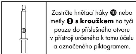
Zastrčte hnětací háky ⑩ nebo metly ⑨ **s kroužkem** na tyči pouze do příslušného otvoru v přístroji určeného k tomu účelu a označeného piktem.
