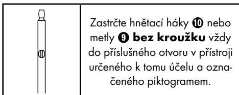
Zastrčte hnětací háky ⑩ nebo metly ⑨ **bez kroužku** vždy do příslušného otvoru v přístroji určeného k tomu účelu a označeného piktem.
