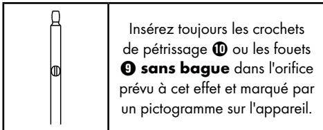
Insérez toujours les crochets de pétrissage ⑩ ou les fouets ⑨ **sans bague** dans l'orifice prévu à cet effet et marqué par un pictogramme sur l'appareil.
