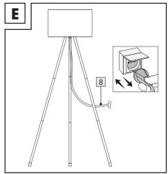
4. Verbinden Sie den Netzstecker 8 mit einer geeigneten Steckdose (Abb. E). Das Produkt ist betriebsbereit.
