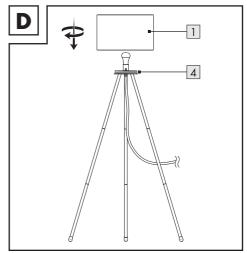
3. Drehen Sie den Lampenschirm 1 im Uhrzeigersinn auf den Leuchtensockel 4 (Abb. D).
