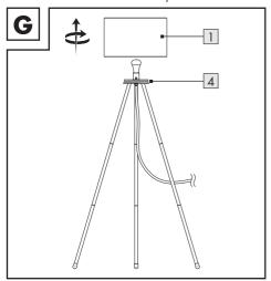
2. Drehen Sie den Lampenschirm 1 entgegen dem Uhrzeigersinn und entnehmen Sie ihn vom Leuchtensockel 4 (Abb. G).
