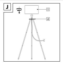
5. Drehen Sie den Lampenschirm 1 im Uhrzeigersinn auf den Leuchtensockel 4 (Abb. J).
