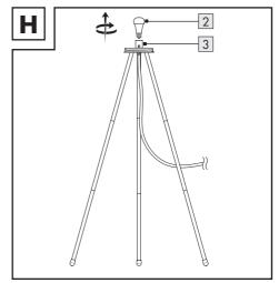
3. Drehen Sie die LED-Lampe 2 entgegen dem Uhrzeigersinn und entnehmen Sie sie aus der Lampenfassung 3 (Abb. H).
