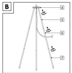
1. Schrauben Sie die Stangen 5 6 7 ineinander. Verbinden Sie die zusammengebauten Stangen mit dem Leuchtensockel 4 (Abb. B).
